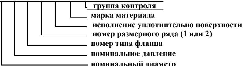
группа контроля<br>марка материала<br>исполнение уплотнительно поверхности<br>номер размерного ряда (1 или 2)<br>номер типа фланца<br>номинальное давление<br>номинальный диаметр |
